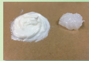
③ 主剤2：硬化剤1の割合でよく混ぜ合わせる。
