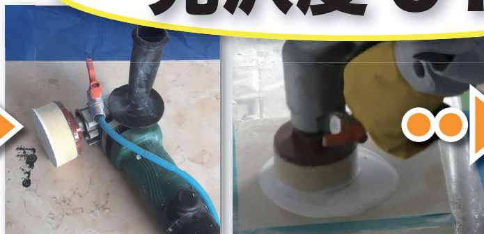
② ポリッシャにフェルトバフを装着して研磨
